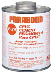
Pegamento de viscosidad gruesa, secado medio y de alta fuerza. Formulado para adherir tuberías y conexiones de CPVC Cédula 40 y Cédula 80 hasta 12" (300 mm) de diámetro. Para uso en sistemas para agua fría y caliente de hasta 180° F (82° C). Se recomienda utilizar el primer PARABOND C-60 antes de la aplicación.
